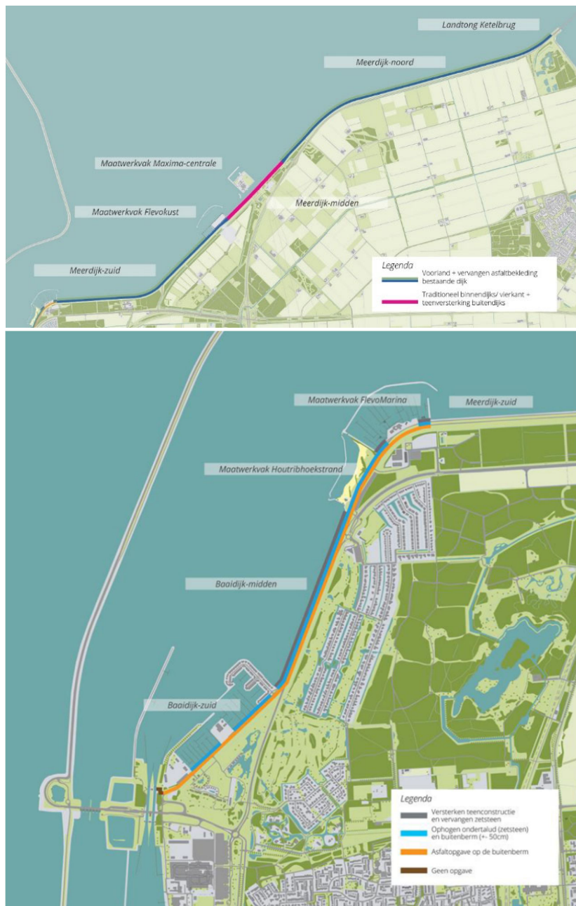
Figuur 4-1 Overzicht methode dijkversterking per deelgebied.
