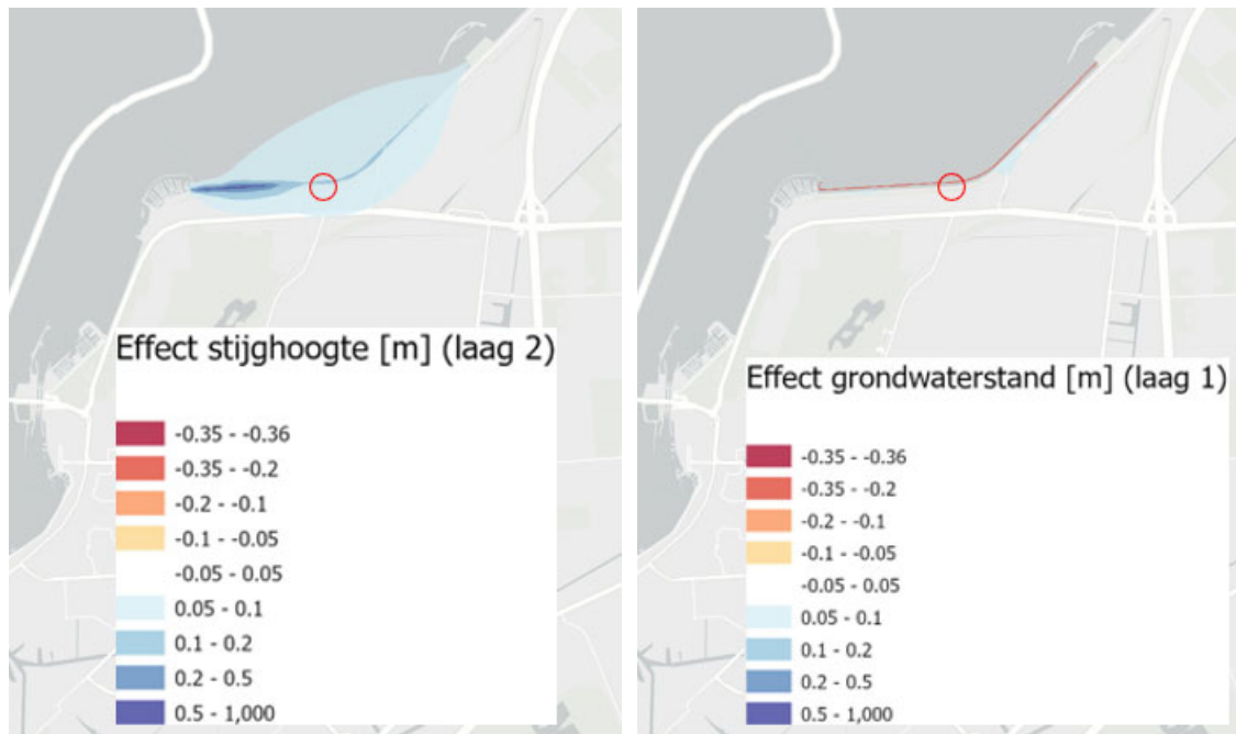
Figuur 6-18 Berekende verandering van de stijghoogte (links) en grondwaterstand (rechts) bij een cunet met restweerstand van 300 dagen. Locatie BioResearch aangegeven met rode cirkel.
