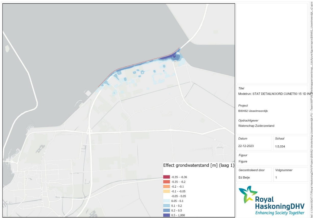
Figuur 6-4 Berekende verandering van de grondwaterstand bij restweerstand ter plaatse van het cunet van 1 dag (11 dagen inclusief infiltratieweerstand). Berekend met detailmodel noordoostelijke deel.
