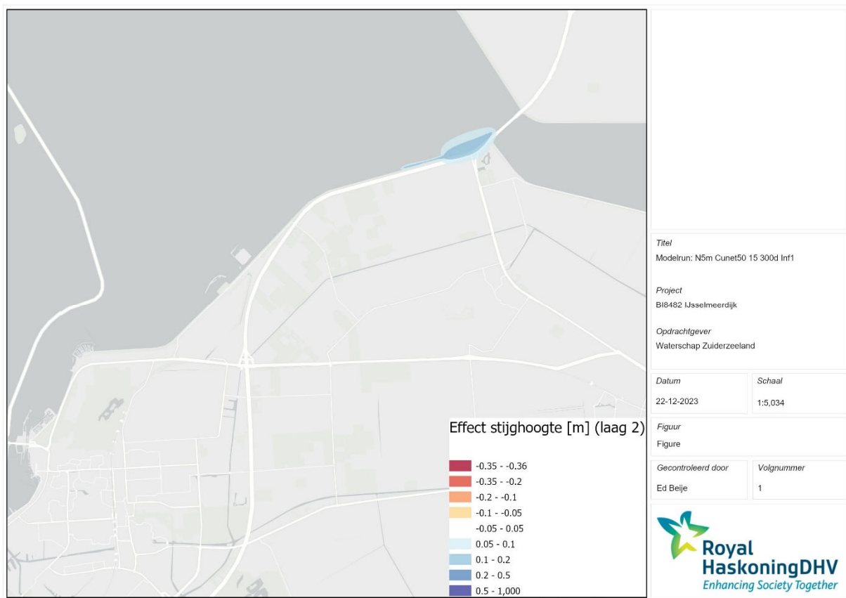
Figuur 6-3 Berekende verandering van de stijghoogte bij restweerstand ter plaatse van het cunet van 150 dagen (160 dagen inclusief infiltratieweerstand). Berekend met detailmodel noordoostelijke deel.
