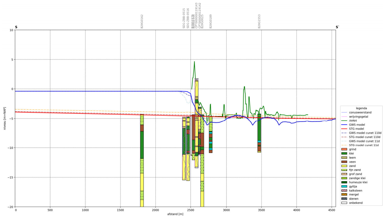
Figuur 6-14 Berekende grondwaterstand en stijghoogte in de referentie en bij twee scenario's met cunet (restweerstand 11 en 110 dagen). Geplot op een doorsnede met daarin ook de bodemopbouw. Raai S.
